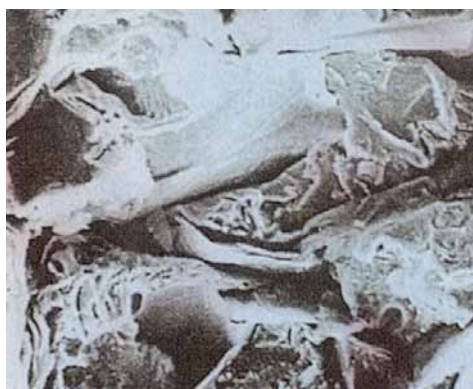
Struttura lamellare originaria della ghisa grigia.
