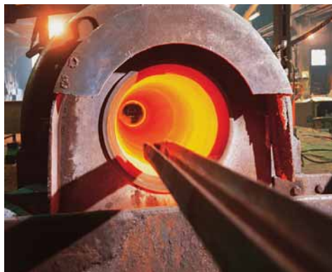
I tubi vengono realizzati per colata centrifugata.
