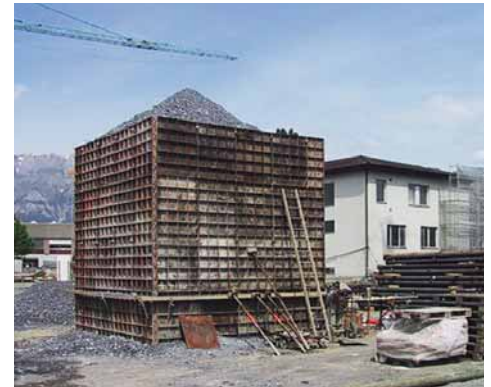
Die Probebelastung eines Pfahles im Eschner Industriegebiet.
