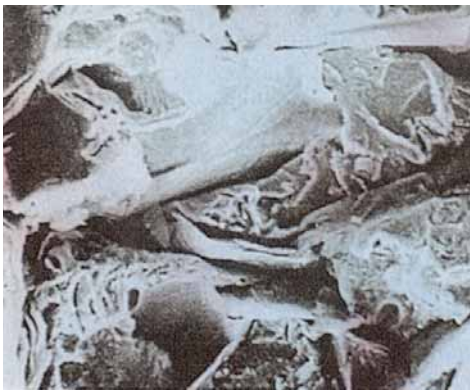
Ursprüngliches lamellenartiges Gefüge des Graugusses.
