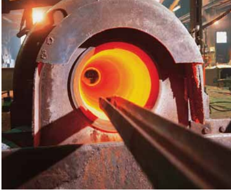
Die Rohre werden im Schleudergussverfahren hergestellt.
